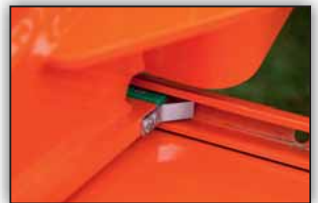
Guides spéciaux en nylon montés sur des glissières afin de permettre un déplacement sans lubrification spécifique.
