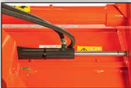
Déport latéral hydraulique de 500mm
